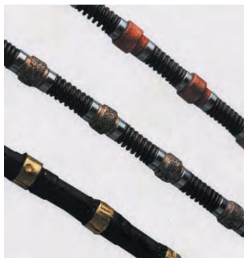
Slika 3. Konstrukcije dijamantne žice (galvanizirane perle (gore); sinterirane perle (u sredini); žica obložena plastikom zbog zaštite čeličnog užeta od prebrzog habanja (dolje)).
