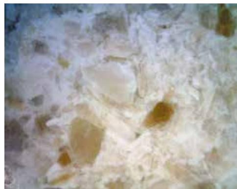
Mikrostruktura kamena snimljena povećanjem od 50 puta
